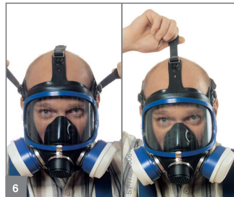
6 Bänder anziehen, bis die Maske dicht und bequem sitzt: Zuerst Nackenbänder gleichmäßig straffziehen. Schläfenbänder gleichmäßig straffziehen. Falls erforderlich zusätzlich Stirrband straffziehen.
