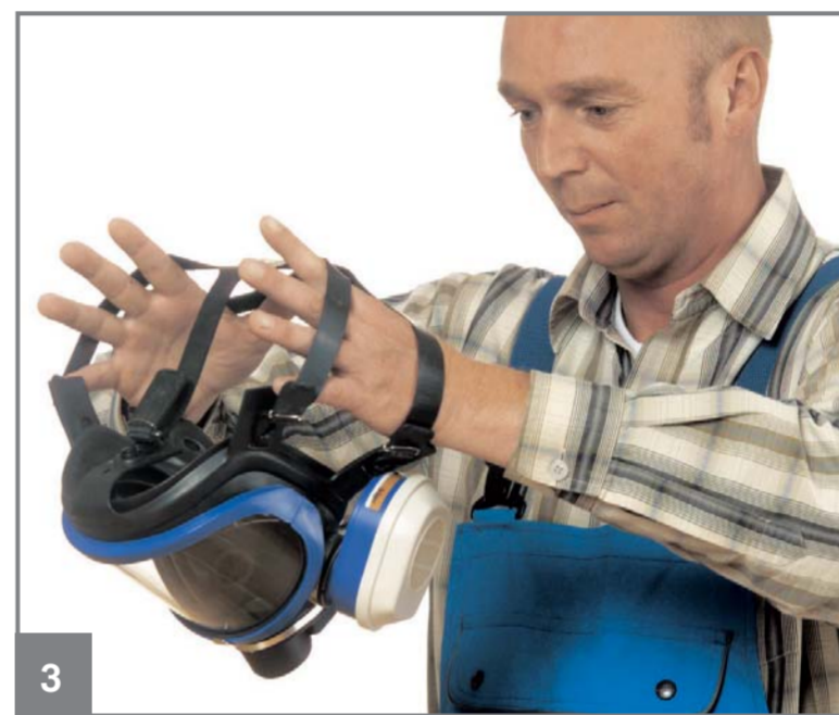
3 Bebänderung bis zum Anschlag öffnen. Maske an das Gesicht führen.
