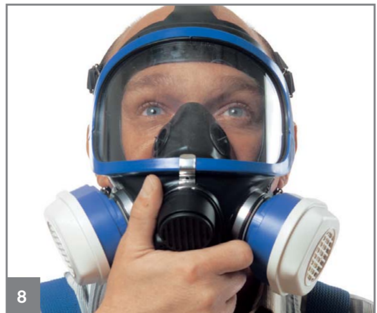
8 Überdruckprüfung: Ausatemventil dichthalten und ausatmen. Die Maske hebt leicht vom Gesicht ab. Falls Luft über den Dichtrahmen abströmt, Maske zurechtrücken und Bebänderung nachziehen. Prüfung wiederholen bis Maske dicht sitzt.
