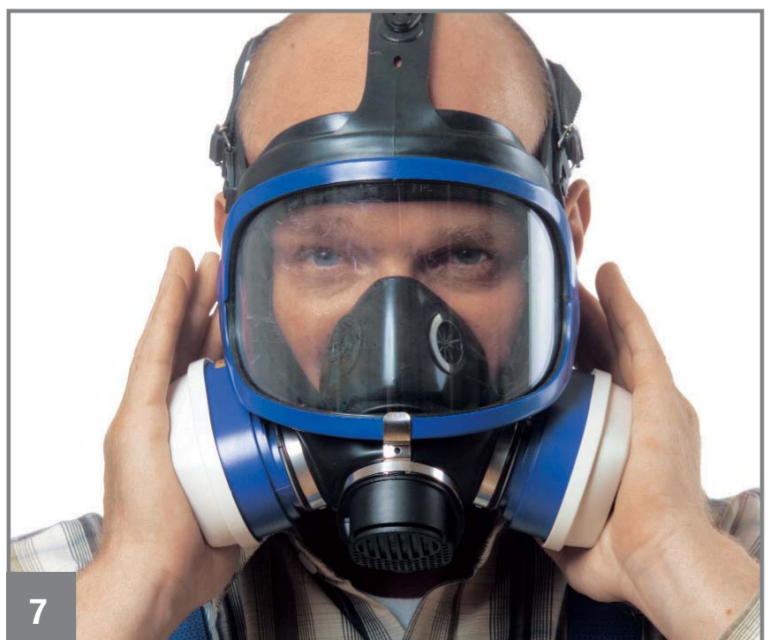
7 Unterdruckprüfung: Beide Filter mit den Händen dichthalten und einatmen, bis Unterdruck entsteht, Luft kurzzeitig anhalten. Der Unterdruck soll bestehen bleiben. Sonst Maske zurechtrücken und Bänder nachziehen. Prüfung wiederholen bis Maske dicht sitzt.
